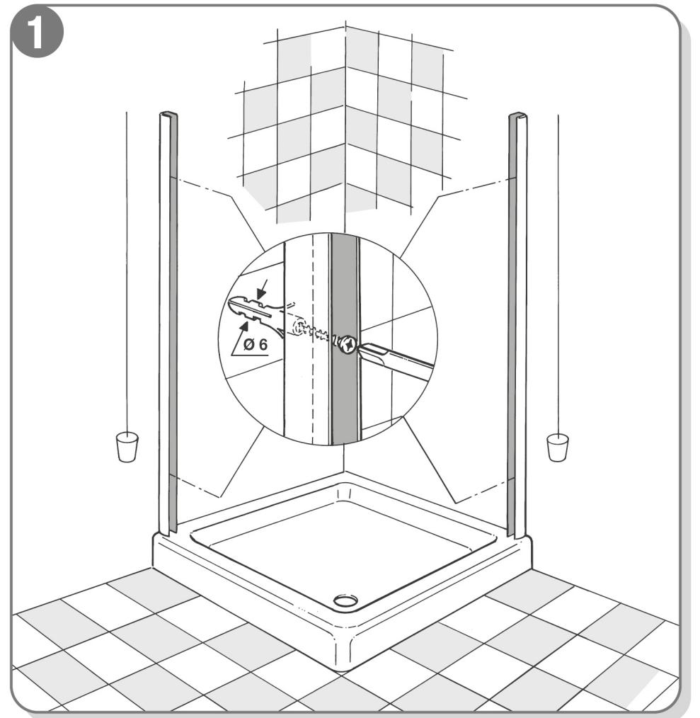
Togliere i due compensatori del box doccia e posizionarli a circa 1 cm dal bordo esterno. Controllare la perpendicolarità degli stessi e segnare il centro del foro (due fori per profilo). Forare con una punta Ø 6. Inserire i tasselli in nylon Ø 6.
