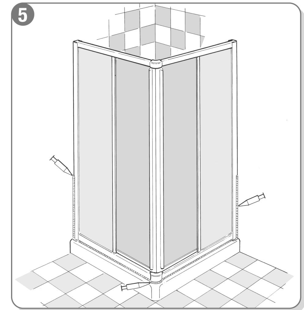
A montaggio finito siliconare solo la parte esterna della cabina doccia.
